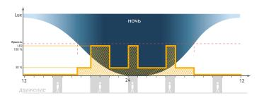
Ф Светильник горит с яркостью 30%, когда темно. При обнаружении движения - включается на 100%.
