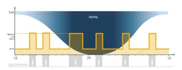
Ф Светильник горит постоянно с настроенной яркостью. При обнаружении движения светильник включается на 100% яркости, независимо от освещенности.
