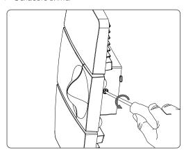
Ослабьте с помощью отвертки зажимы и отделите Основание от Светильника
