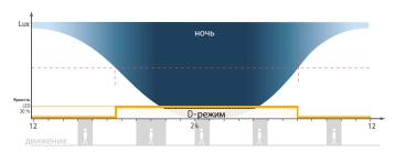
Ф Прибор реагирует только на освещенность. Светильник включается на установленную яркость (10%-60%), если значение освещенности ниже установленного.
