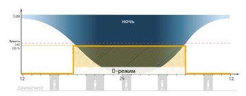
• Прибор реагирует только на освещенность. Светильник включается на полную яркость, если значение освещенности ниже установленного.
