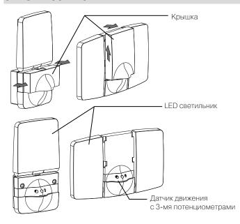
Ф Прибор имеет 3 потенциометра для настройки времени задержки отключения (min), порога срабатывания по освещенности (lux) и Режима работы (mode).
